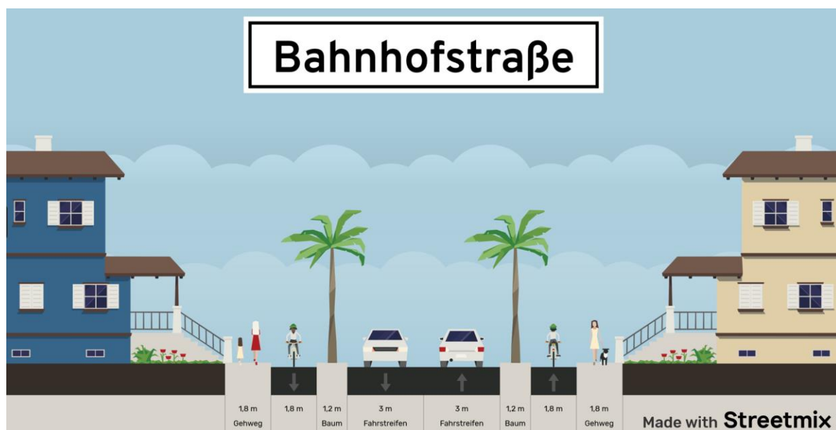
Abbildung 90: Vorgeschlagener Querschnitt der Bahnhofstraße Beispiel 1 ( streetmix.net )
