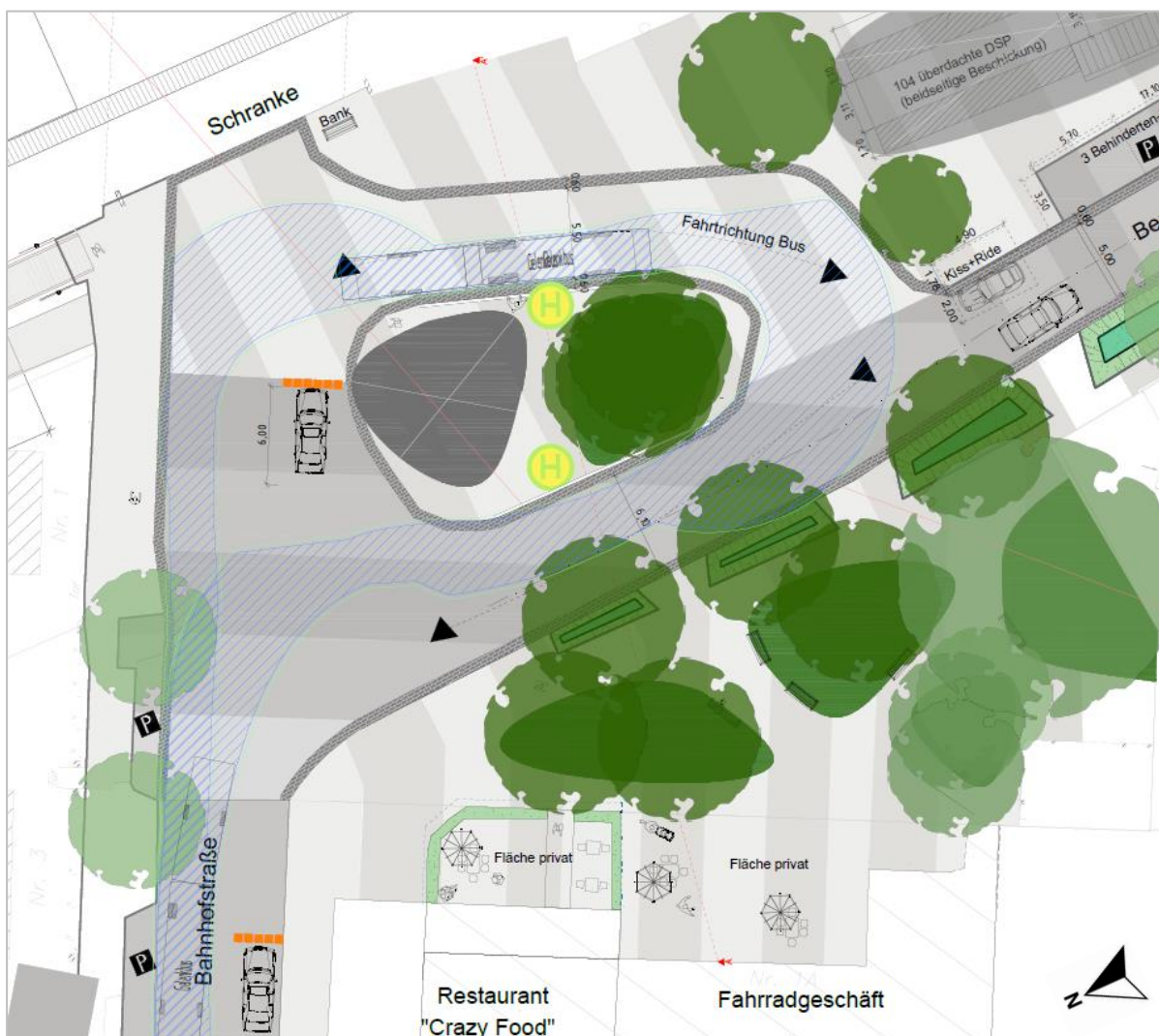
Abbildung 110: Schleppkurve eines Gelenkbusses auf dem Rondell des Fürstenaue Platzes (eigene Darstellung; Plangrundlage agu Goldmann)
